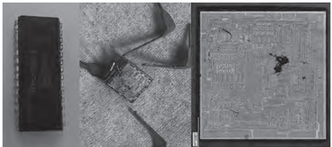
Abb. 8: Fotografie der Oberfläche des AY-3-8500-IC
