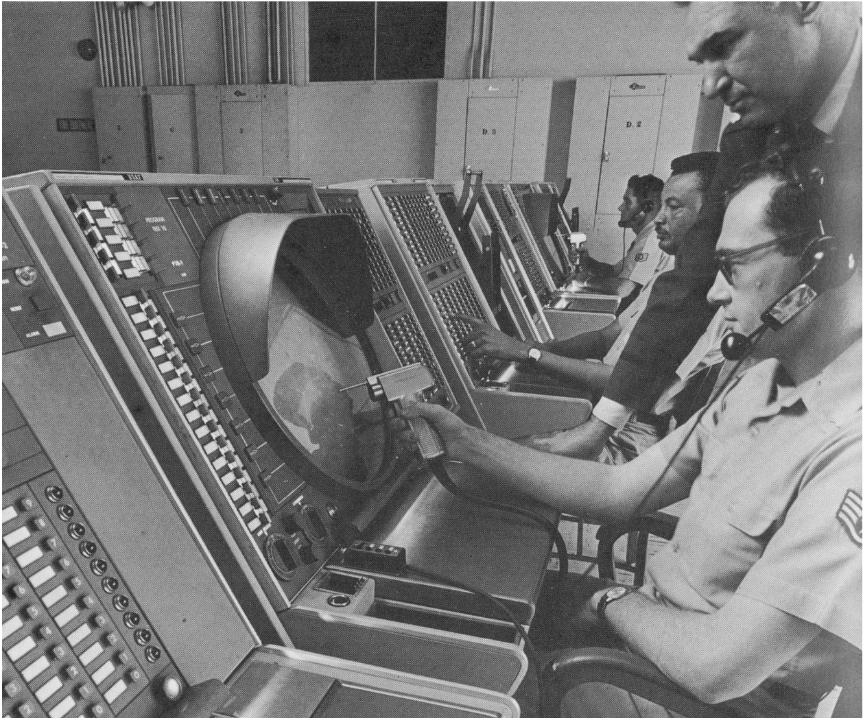
Abb. 128: Das ›SAGE Direction Center‹ mit dem Lightgun-Interface, hier im Nachbau des SDC System Training Office (APASTO).
